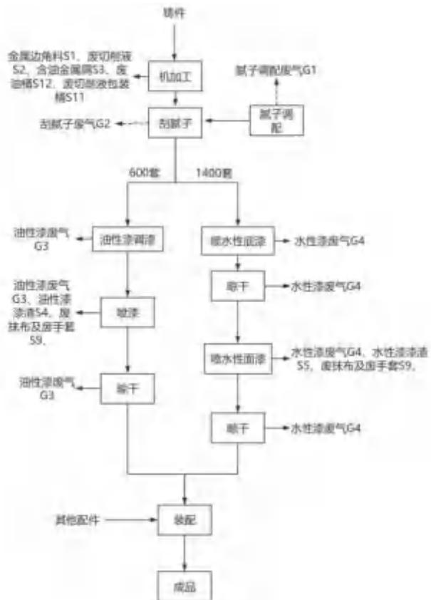
图 2-1 机床生产工艺流程及产污环节示意图
