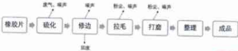
橡胶鞋底生产工艺及产物环节图
