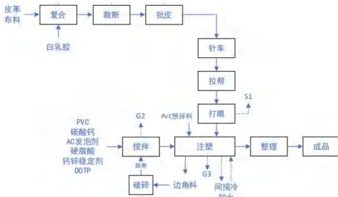
图2-4 生产工艺流程及产污环节示意图
