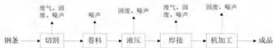
图2-4 生产工艺及产污流程图
