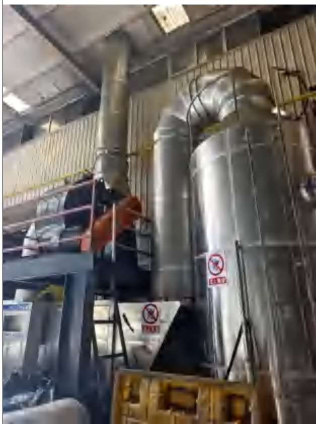
1#燃烧、熔化、浇注、压铸和脱模废气处理设施
