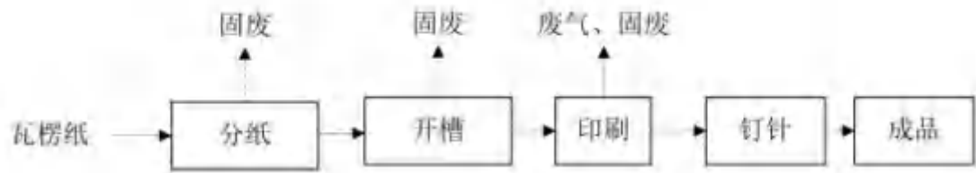
图2-4 纸箱生产工艺流程及产污环节示意图
