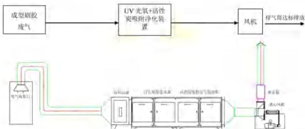
废气收集→UV光氧+活性炭吸附废气处理箱→引风机→达标排放
