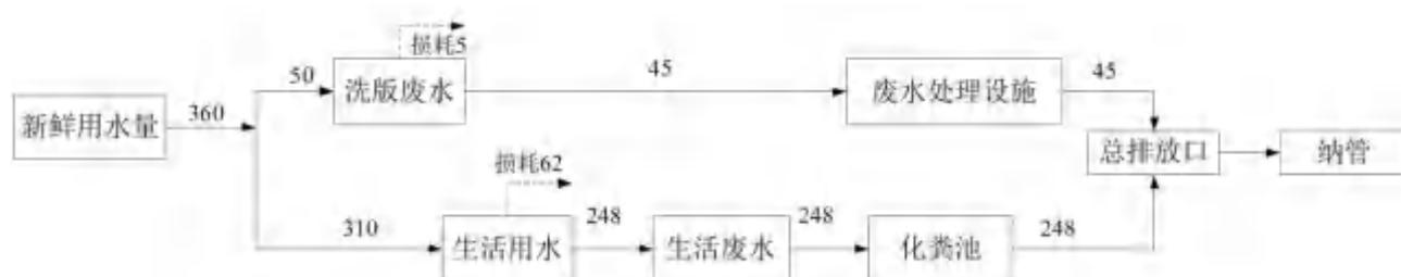
图2-3 折算后年水平衡图
