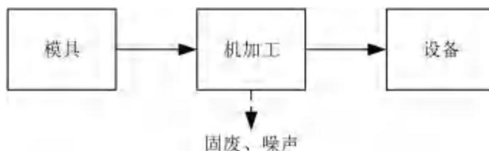
图2-5 模具维修工艺流程及产污环节示意图
