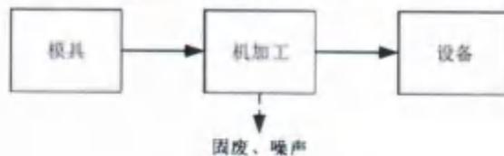
模具维修工艺流程
