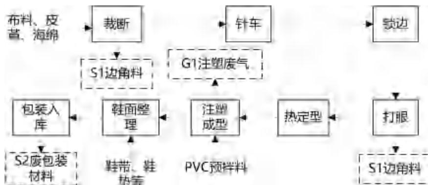
图2-4 生产工艺流程及产污环节示意图
