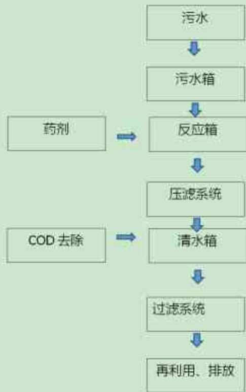
图 2-1 超声波废水处理工艺流程图
