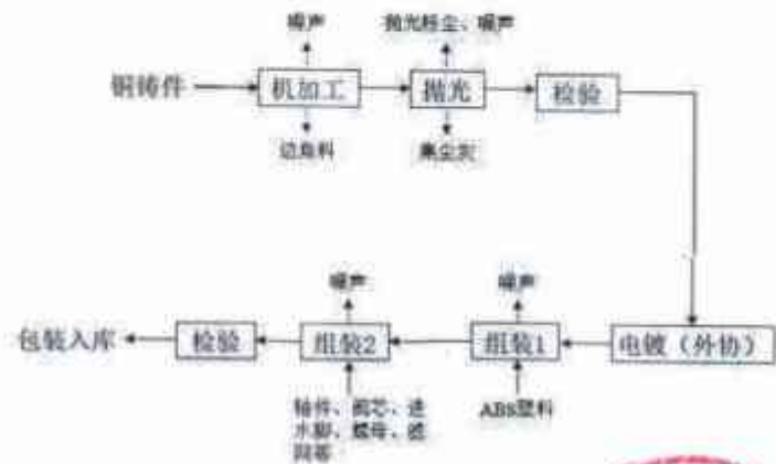
生产流程及产污环节示意图
