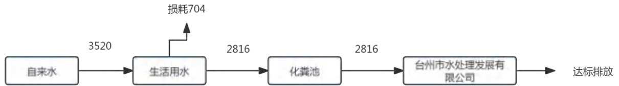
图 3-3 水量平衡图 单位: t/a
