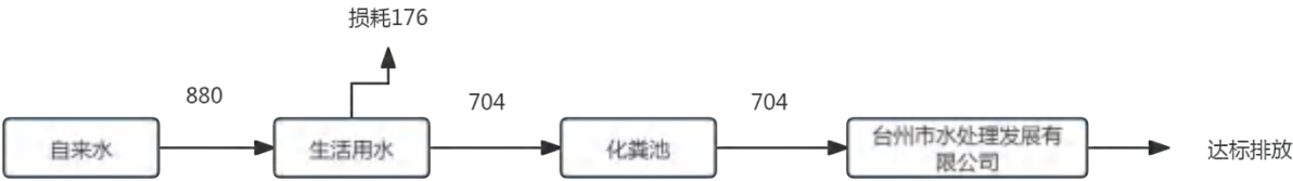
图 7-1 2025 年 2-4 月水量平衡图 单位：吨
