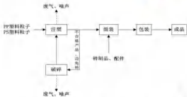
图 2-4 本项目圆规生产工艺流程及产污环节示意图
