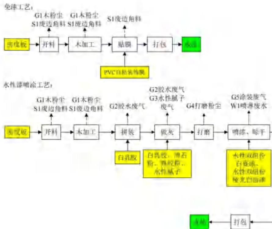
图2-4 生产工艺流程及产污环节示意图
