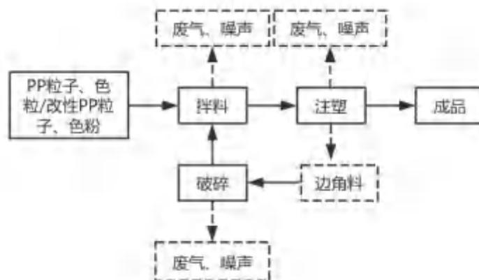
图2-4 项目生产工艺及产污环节示意图
