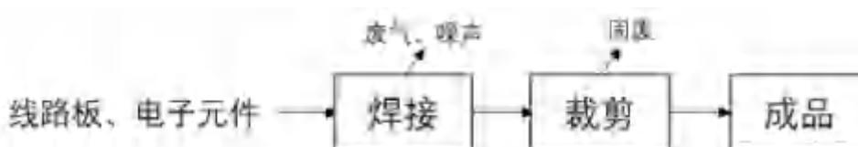
图2-5 剃须刀线路板生产工艺及产污流程图
