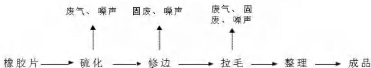
图2-4 橡胶鞋底生产工艺流程及产污环节示意图
