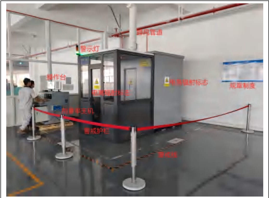
图 6-1 探伤机房全景
