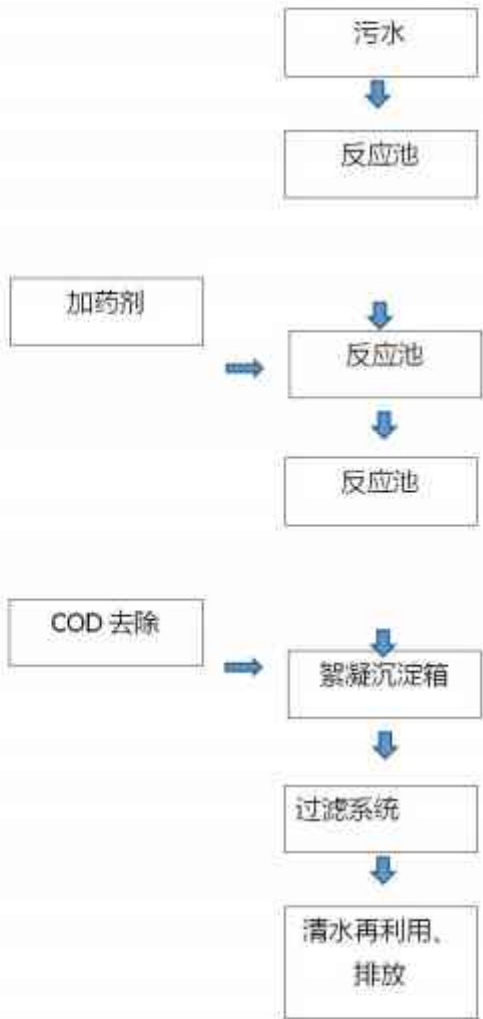
图 2-1 超声波废水处理工艺流程图
