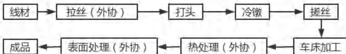
图2-3 螺丝、螺栓及部分配件生产工艺流程图
