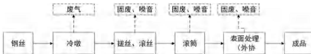
图 2-3 标准件工艺流程图
