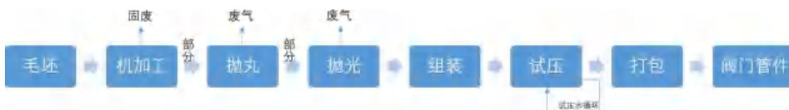
图 2-2 项目工艺流程及产污环节示意图（阀门管件）
