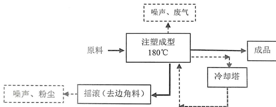
图2-2 项目生产工艺及产污环节示意图
