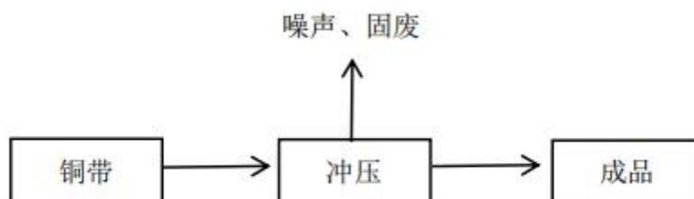
图2-2 项目生产工艺及产污环节示意图
