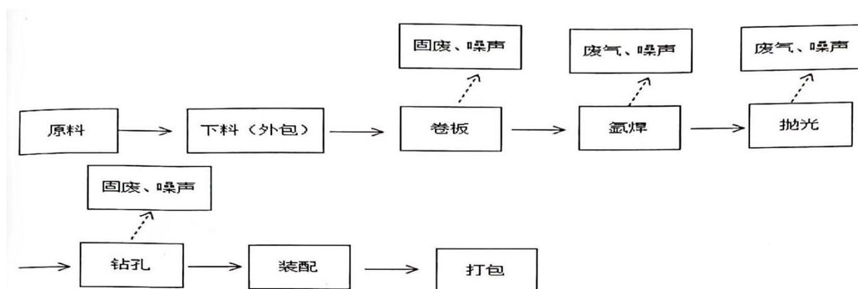
图2-2 项目生产工艺及产污环节示意图
