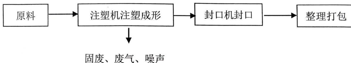
图2-2 项目生产工艺及产污环节示意图
