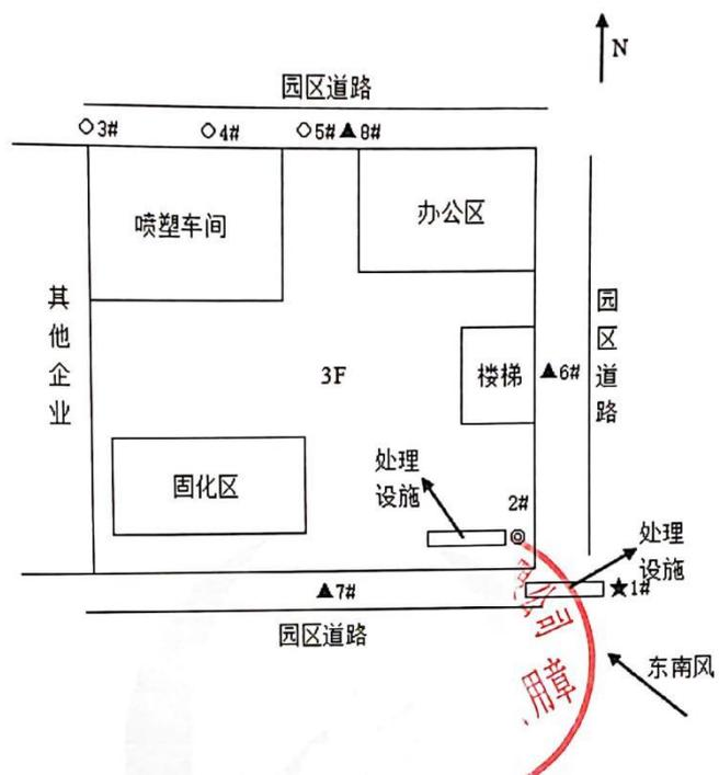
◎-有组织废气采样点; ○-无组织废气采样点; ★-废水采样点; ▲-工业企业厂界环境噪声采样点
