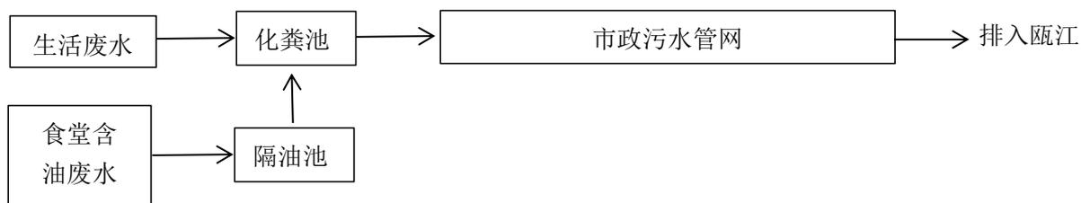
图3-1 废水处理工艺流程图
