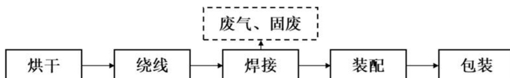
电抗器生产工艺流程
